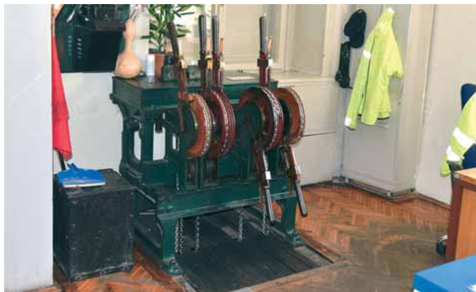
Mehanički uređaj za upravljanje željezničkim skretnicama
