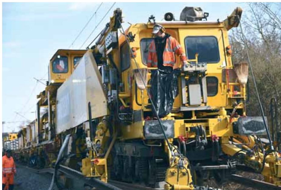
Stroj za brzu izmjenu kolosijeka SMD 80
