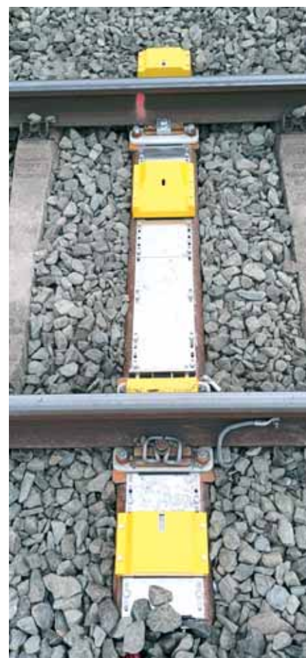
Sustav za mjerenje temperature osovinskih ležajeva, kočnih diskova i oboda kotača
