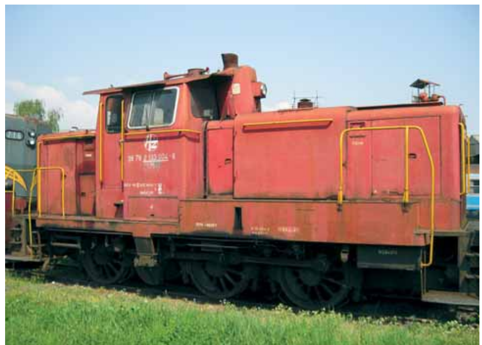
Dizel-hidraulična lokomotiva serije HŽ 21 33
