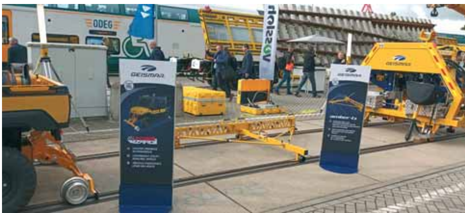
Geismar Amber-t kolica za mjerenje i prikaz svih parametara geometrije kolosijeka
