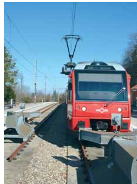
Specifičan pantograf koji je pomaknut izvan središta kolosijeka i vozila
