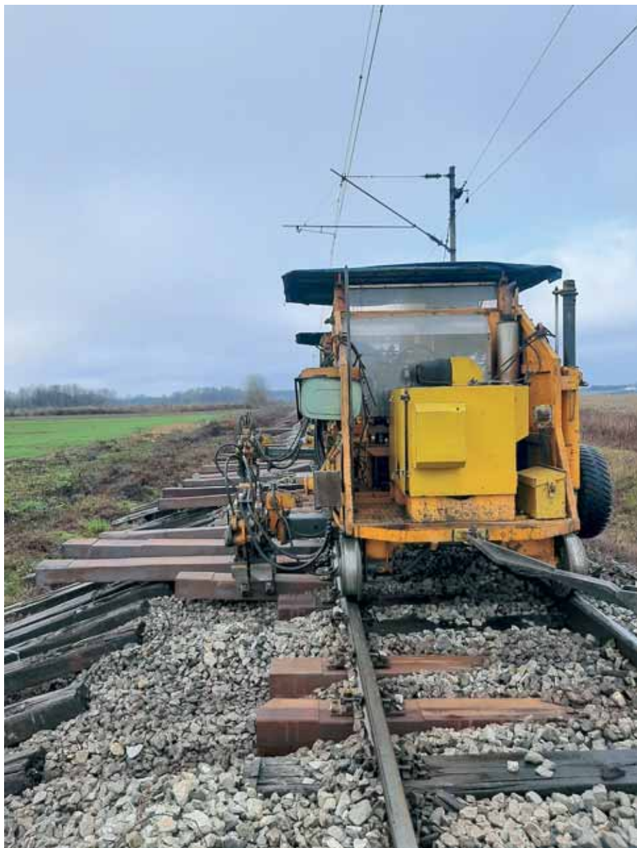
Stroj za pojedinačnu zamjenu pragova
