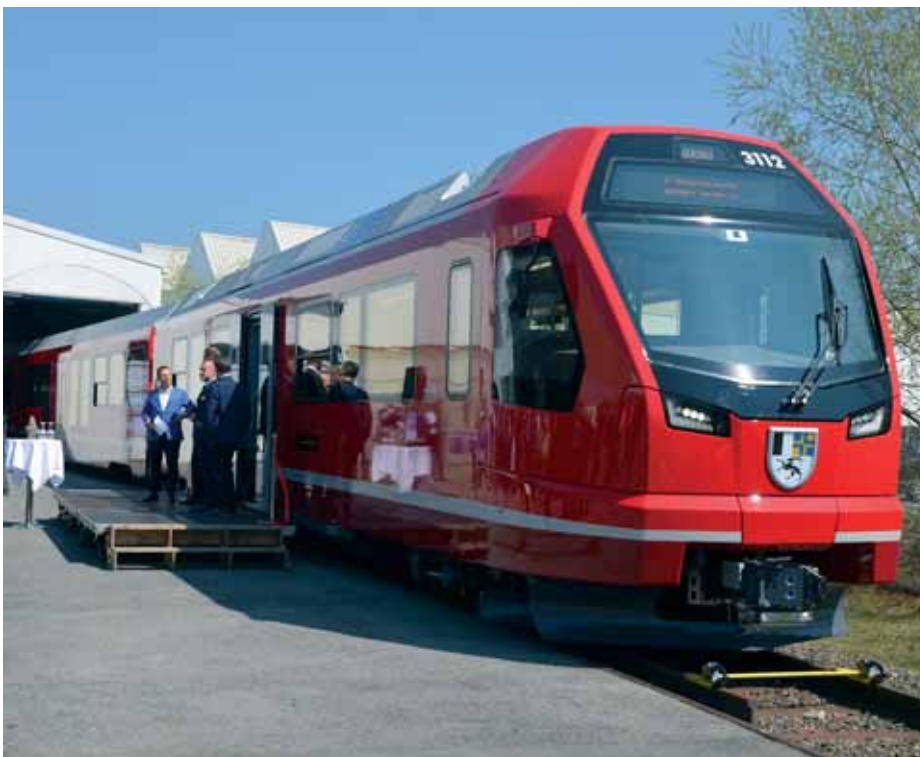
Četverodijelni elektromotorni vlak Capricorn je djelomično niskopodan
