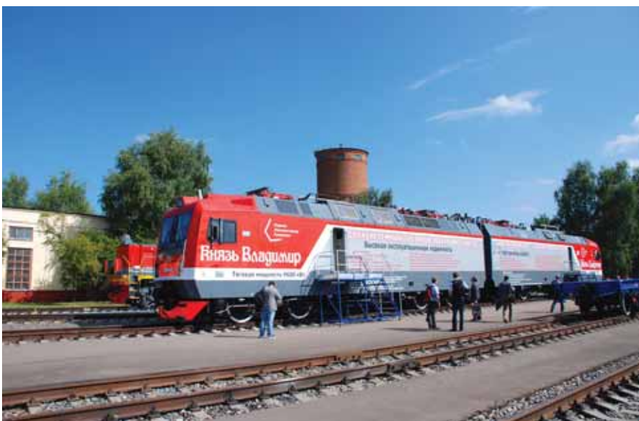
Dvostruka elektrolokomotiva TRAXX namijenjena tržištu širokog kolosijeka
