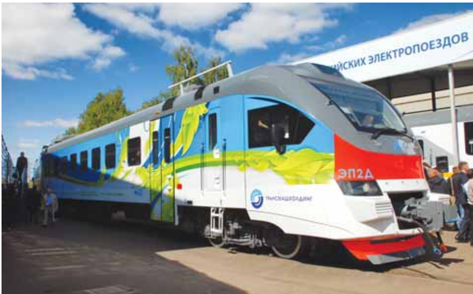
Elektromotorni vlak EP2D namijenjen za pruge s malim brojem putnika
