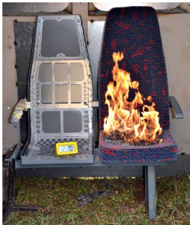
Testiranje samogasivosti materijala
