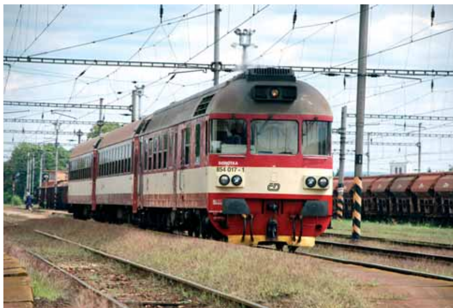
Lokalni vlak tvrtke ČD za neelektrificirane pruge serije 854
