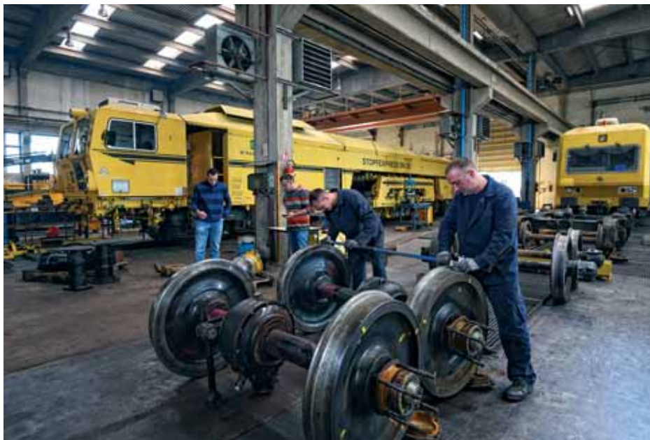
Mjerenje eventualnih odstupanja na kotačima
